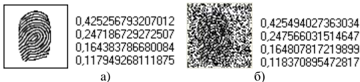
Рис.3 Действие аддитивного шума на инварианты к смещениям: а) изображение и инварианты без шума, б) изображение и инварианты при соотношении \psi = 0,2(\sigma = 5) .
