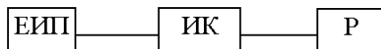
Рисунок 3 – Структурная схема измерителя СПЕФВ-ЕК: ЕИИП – емкостной измерительный преобразователь; ИК – измерительный кабель; Р – регистратор
