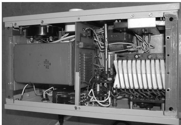
Рисунок 3 – ГИТ-АЭС со снятой верхней крышкой
