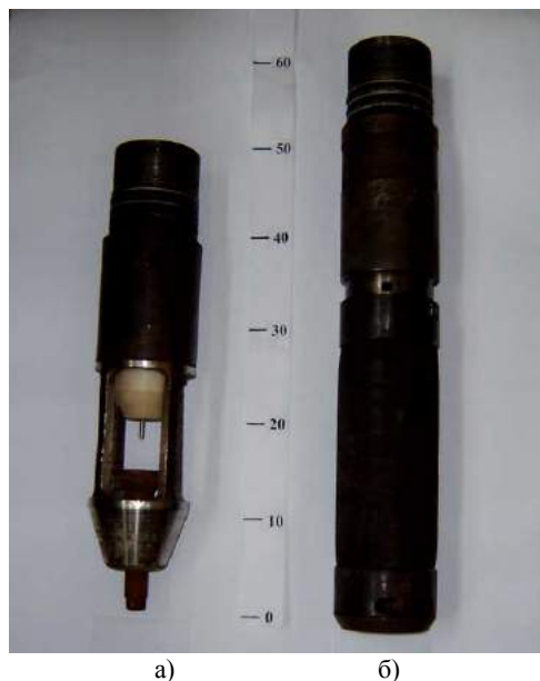
Рисунок 9 – Внешний вид электродных систем: а) – открытая электродная система; б) – закрытая электродная система
