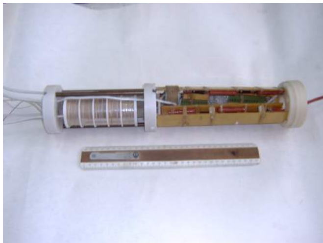
Рисунок 4 – Выемная часть зарядного блока погружной установки
