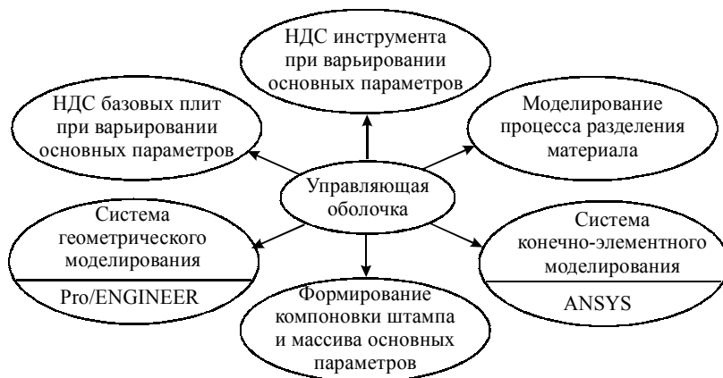
Рисунок 2 – Структура специализированной интегрированной системы автоматизированного исследования элементов технологической оснастки тонколистовой штамповки
