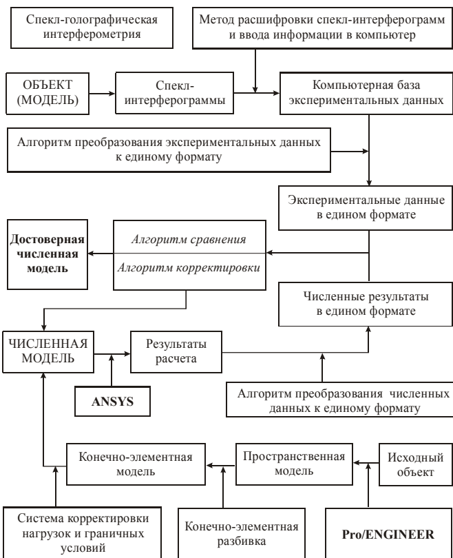
Рисунок 5 – Взаимодействие модулей созданного СПАК на базе метода конечных элементов и спекл-голографической интерферометрии
