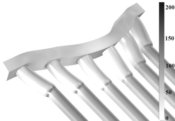
Рис. 3. Деформація елементів ДСР СГ-500
