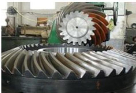
Рис. 4 – Контроль настановних зсувів конічних колес з круговим зубом на контрольно-обкатному стенді
