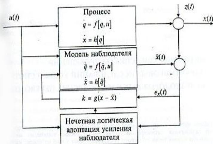
Рис.2. Структурная схема гибридного "наблюдателя"
