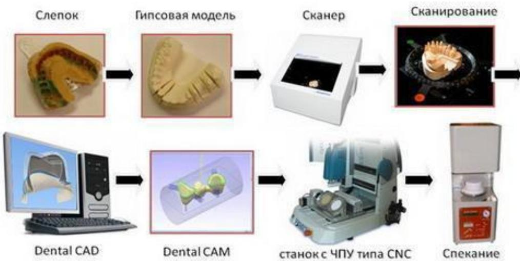
Рисунок 1 – Технологічна схема виготовлення зубних протезів з використанням сучасних CAD/CAM технологій
