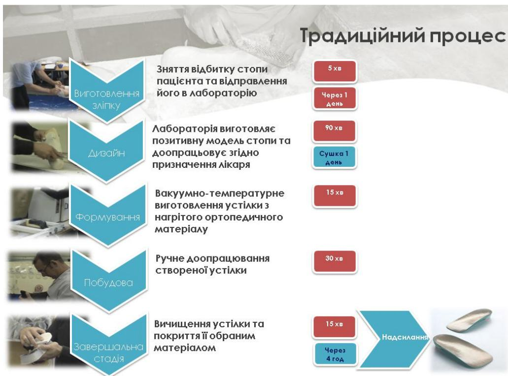
Рисунок 4 - Традиційні процеси виготовлення ортопедичного взуття та устілок
