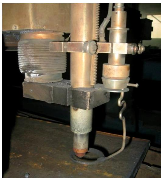
Рисунок 5 – Резак плазменной резки
