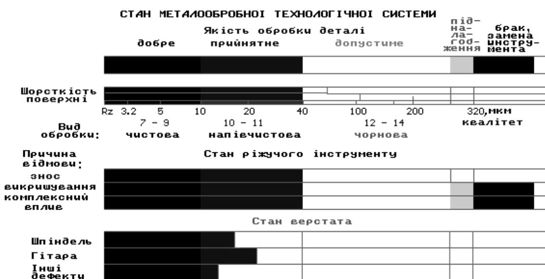
Рисунок 6 – Інформація про стан металообробної системи, яка виводиться на дисплей монітору
