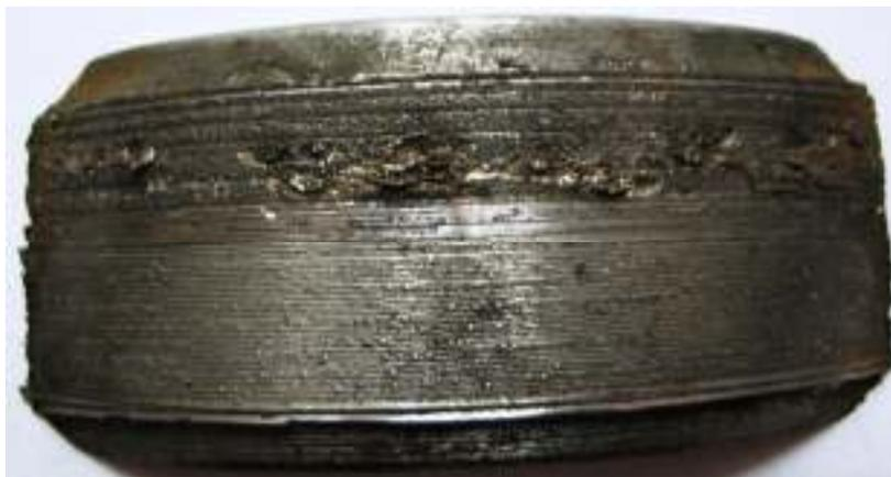
Рисунок 4 – Вигляд поверхні після дискретного зміцнення (до шліфування)
