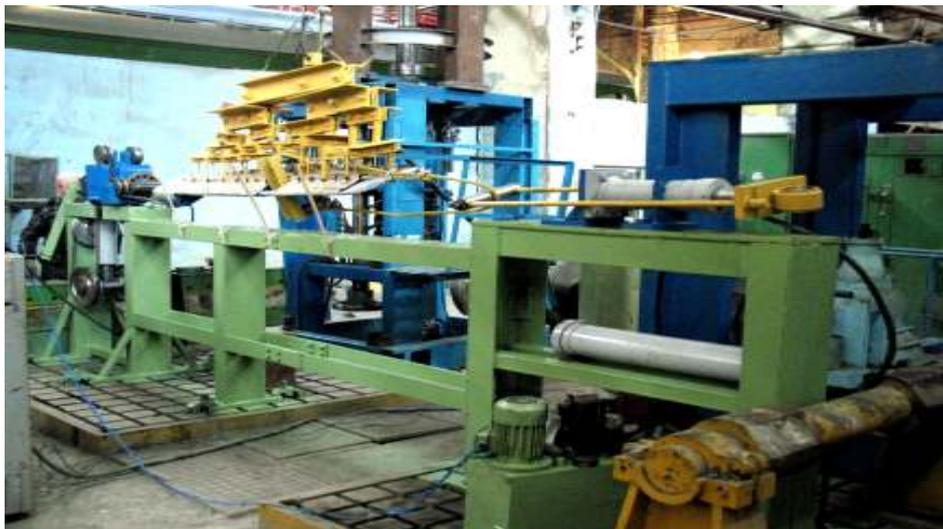
Рисунок 7 – Стенд статических испытаний ВИГ
