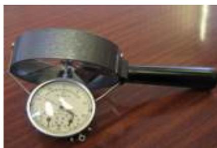
Анемометр крыльчатый АСО-3
