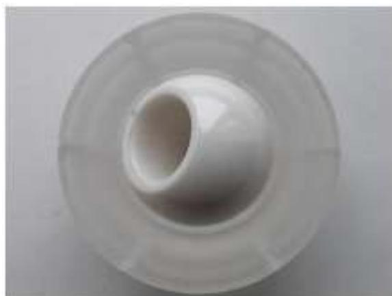
Рисунок 2 – Пара трения вкладыш вертлужной чаши из сапфира – бедренная головка из ZrO<sub>2</sub>-керамики.
