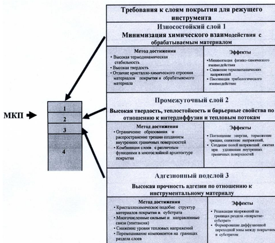
Рисунок 2 – Систематизация основных требований к слоям МКП , исходя из его двойственной природы: 1 – наружный (износостойкий) слой; 2 – промежуточный (барьерный) слой; 3 – адгезионный подслой; 4 – субстрат (инструментальный материал); ИК - износостойкий комплекс.
