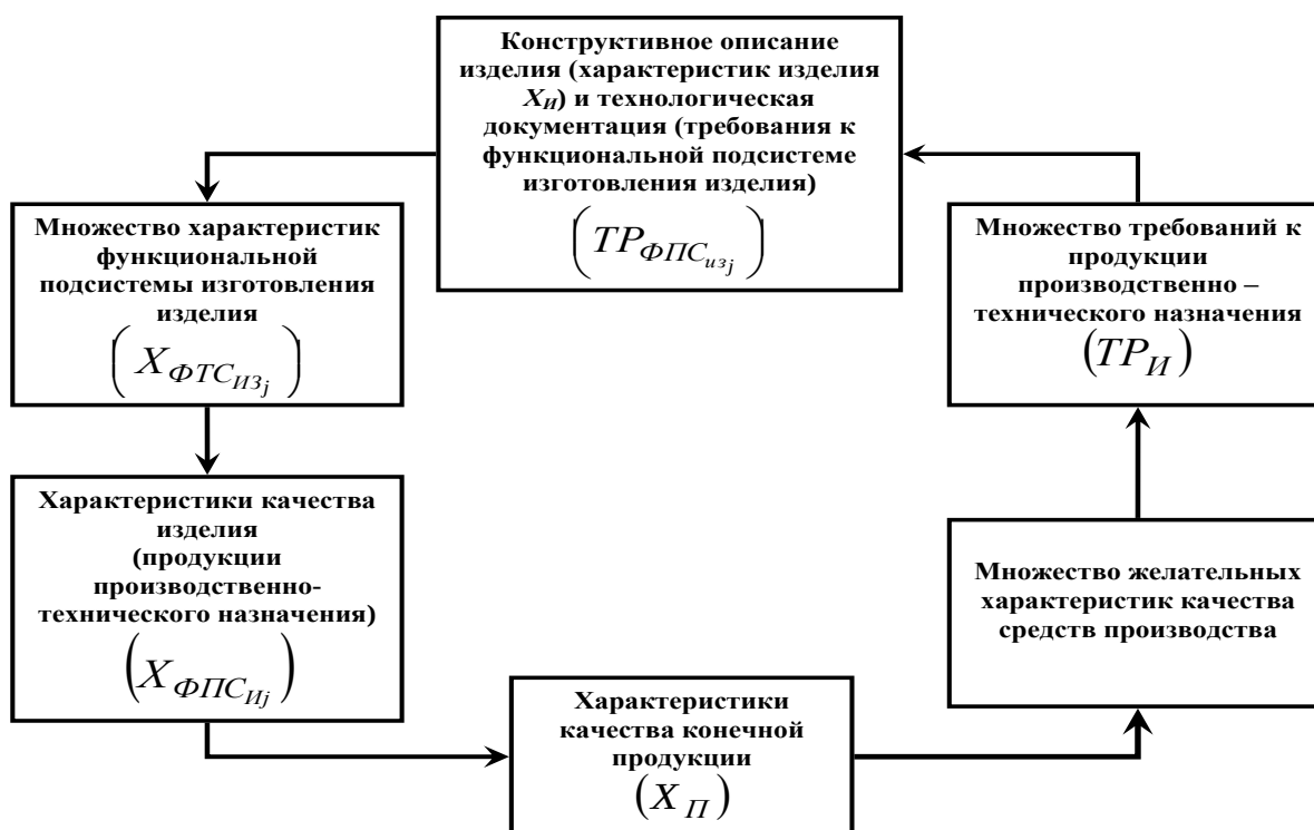
Рисунок 3 – Схема направленного формирования свойств изделий
