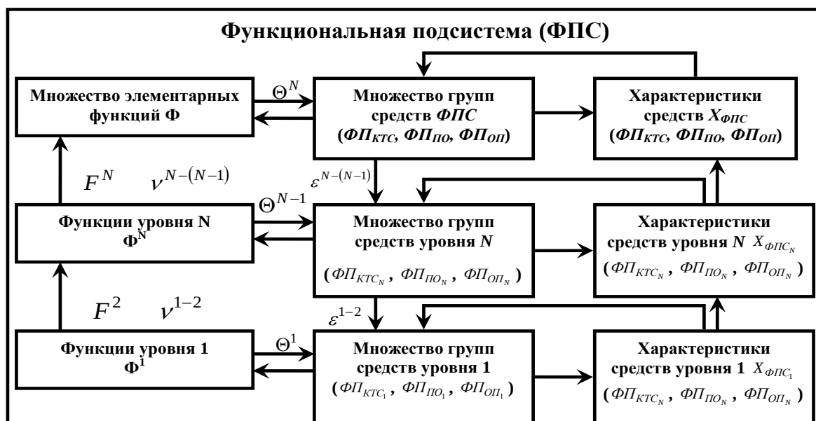
Рисунок 2 – Структура функциональной подсистемы
