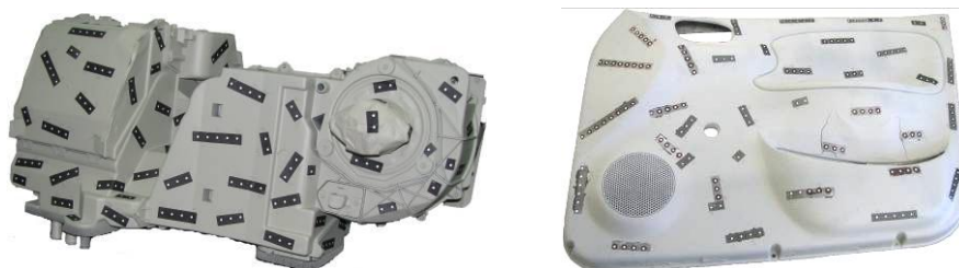
Рисунок 3 – Объекты (отопительная печь и обшивка передней двери автомобиля) подготовленные для сканирования на оптико-цифровой установке
