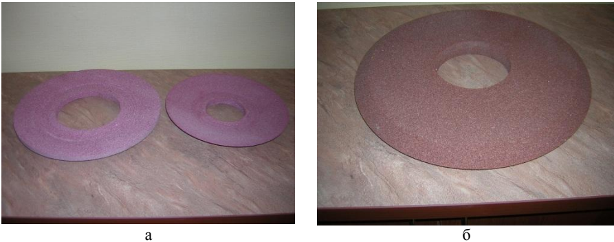
Рисунок 3 – Шлифовальные круги из хромистого корунда: а) тарельчатые круги для станка «MAAG», б) конический круг для станка «Niles» - «ZSTZ»
