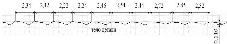
Рисунок 6 – Профилограмма поверхности после встречного фрезерования
