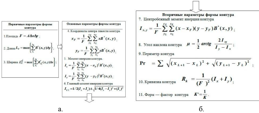
Рисунок 1 – Некоторые из зависимостей для определения первичных, основных (а) и вторичных (б) признаков формы контуров поверхностных дефектов и компонентов структур материалов
