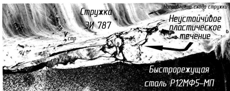
Рисунок 22 – Вид контактного взаимодействия стружки и передней поверхности инструмента при точении сплава ЭИ787:
