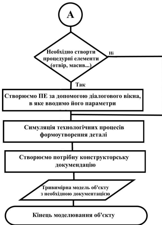
Рисунок 1 – Алгоритм створення тривимірної моделі деталі у синхронному середовищі CAIP Solid Edge
