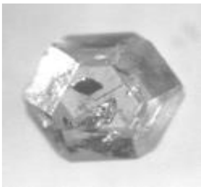
Рисунок 1 – Снимок монокристалла алмаза с локальным включением металла-катализатора
