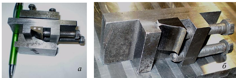
Рисунок 2 – Підготовка мікрошліфів на вирізаних фрагментах зубів (зразках): закріплення зразка в пристосуванні (а) і на столі верстата (б)
