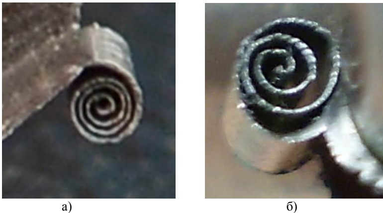
Рисунок 3 – Фрагменти стружкоутворення при вільному ортогональному різанні сталі 12Х15Г9НД (АISI 201), зміцненої по схемі поперечного стиску з деформацією 46%, у середовищі ріпакової олії (а) та сульфозфрезолу Р (б)
