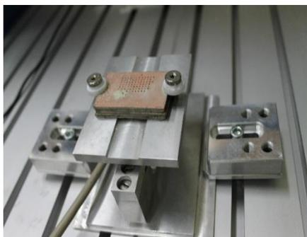
Рисунок 1 – Прибор для измерения осевого усилия
