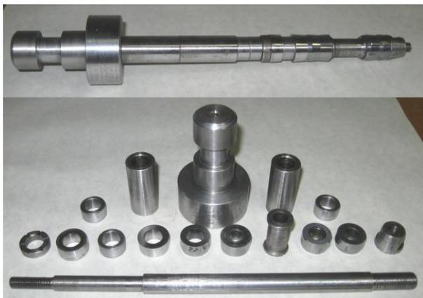
Рисунок 5 – Загальний вигляд комбінованої протяжки та її складові частини
