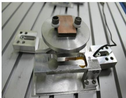
Рисунок 2 – Прибор для измерения крутящего момента
