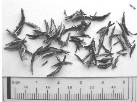
Рисунок 9 – Зовнішній вид стружки, що утворилась після обробки дослідним інструментом
