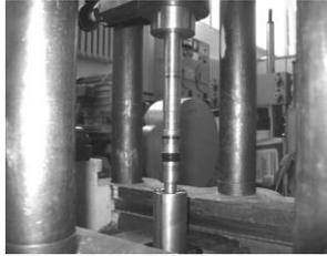
Рисунок 7 – Робоча зона випробувальної машини УИМ-50 із встановленим дослідним інструментом
