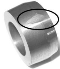
Рисунок 4 – Деформуючий елемент із стружкоподільними канавками
