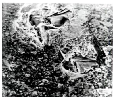
Рисунок 2 – Появление на режущей поверхности круга вскрываемых алмазных зерен
