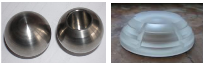
Рисунок 3 – Экспериментальные образцы титановой головки и сапфировой чашки для эндопротеза тазобедренного сустава
