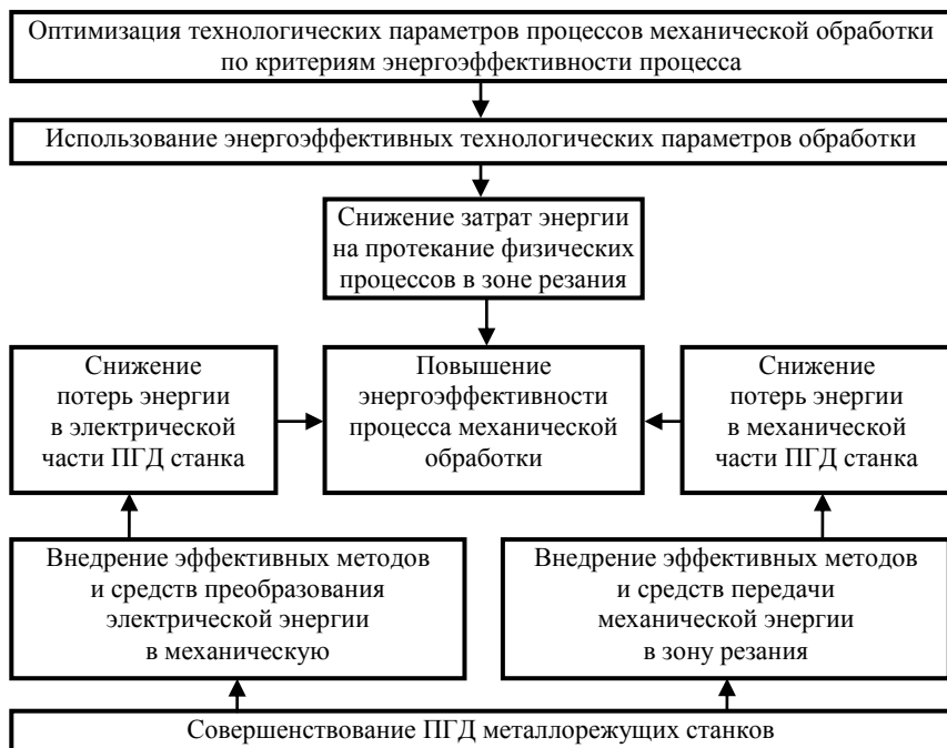
Рисунок 1 – Направления повышения энергоэффективности процессов механической обработки деталей на тяжелых токарных станках
