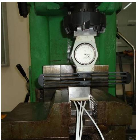
Рисунок 2 – Установка для определения контактных нагрузок
