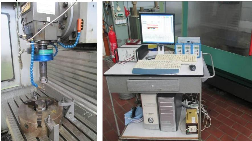
Рисунок 2 – Общий вид и приборное обеспечение экспериментальной установки на базе станка с ЧПУ «МАНО MN 600Е»
