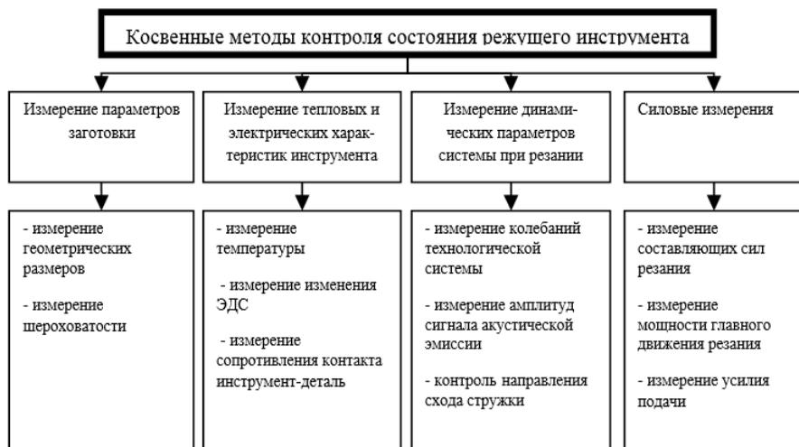
Рисунок 2 – Косвенные методы контроля состояния режущего инструмента
