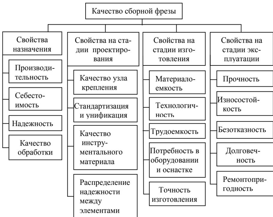
Рисунок 1 – Структура комплексных свойств, составляющих качество сборной фрезы
