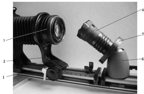
Рисунок 3 – Фрагмент стенда для предварительного лабораторного анализа состояний режущей части СГС (1 – корпус, 2 – стойки крепления оптики, 3 – окуляр, 4 – головка ВТА, 5 – поворотный диск для вращения головки вокруг оси, 6 – устройство для вспомогательных поворотов головки).
