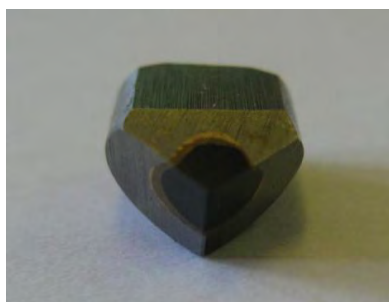
Рисунок 2 – Стандартная вставка оснащенная эльбором-Р (а) и опытные двухслойные пластины (б): 1 –слой КНБ; 2 – твердосплавный субстрат (WC-TaC-Co)-КНБ
