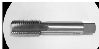
б) Метчик М24х3 Р6М5 ISO 529 \gamma=7^\circ , \alpha=8^\circ , \varepsilon=0^\circ , \varphi=8^\circ
