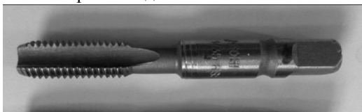
а) Метчик М10х1,5 Р6М5 по ГОСТ 3266-81 \gamma=7^\circ , \alpha=8^\circ , \varepsilon=0^\circ , \varphi=18^\circ
