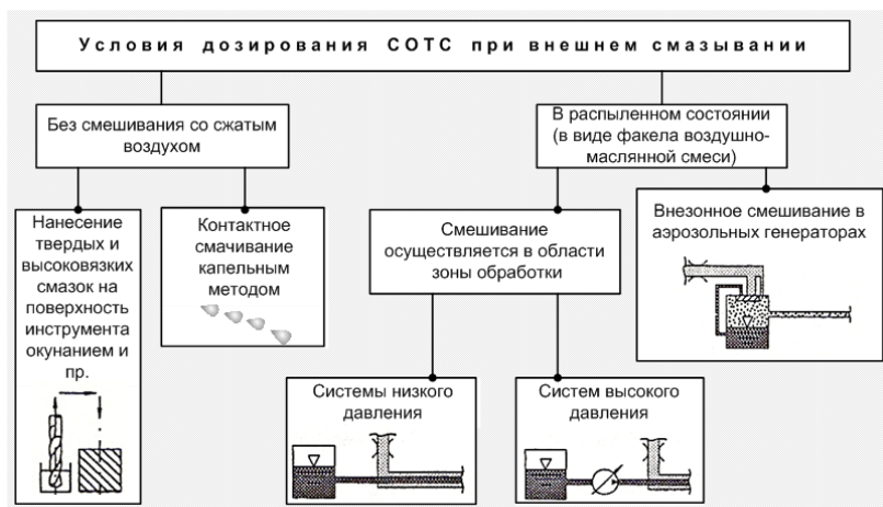
Рисунок 3 – Основные варианты подачи СОТС в зону обработки при внешнем смазывании
