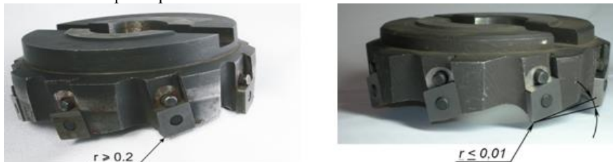
Рисунок 4 – Базовая черновая торцовая фреза с боковым креплением МНП, имеющих радиус при вершине r \geq 0,2 мм и новая фреза для чистовой обработки, с дополнительной заточкой вершин пластин с r \leq 0,01 мм.
