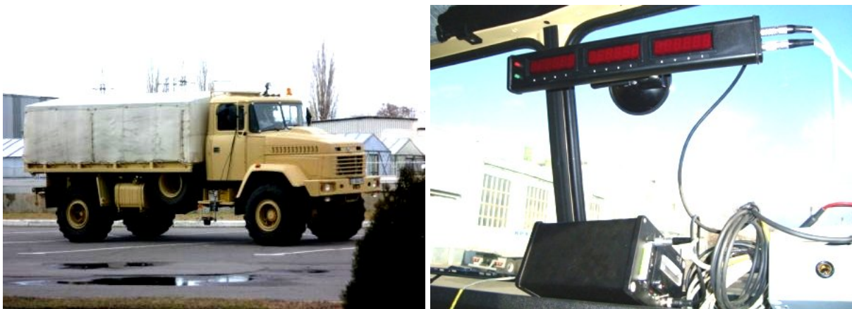
Рис. 4. Общий вид автомобиля КрАЗ-5322BE и установка на него измерительной аппаратуры
