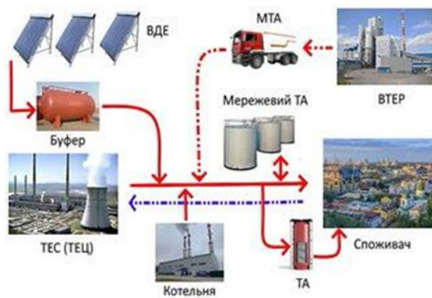
Рисунок 2 – Інтеграція теплових акумуляторів в систему центрального опалення
