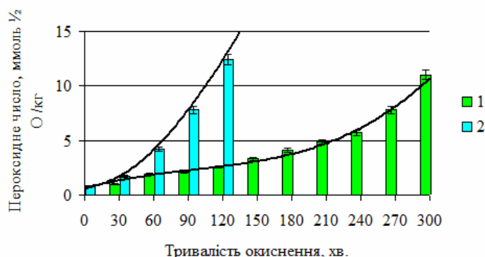
Рисунок 1 – Динаміка накопичення гідрпероксидів прискореним методом: 1 – ліпідний розчин \beta -каротину з біомаси Blakeslea trispora (0,01 %), збагачений поліненасиченими жирними кислотами і природними антиоксидантами; 2 – контрольний зразок – ліпідний розчин \beta -каротину з біомаси Blakeslea trispora (0,01 %), збагачений поліненасиченими жирними кислотами
