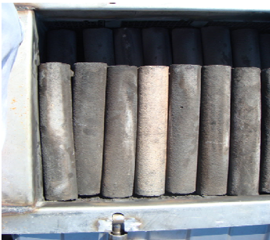
Рисунок 5 – Зовнішній вигляд керамічних трубок-носіїв з нанесеним каталізатором \text{Co}_3\text{O}_4
