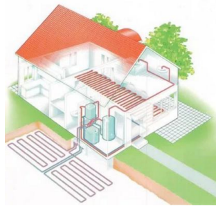
Рисунок 2 – Схема горизонтального геотермального грунтового теплового насоса с расположением теплых полов на этажах
