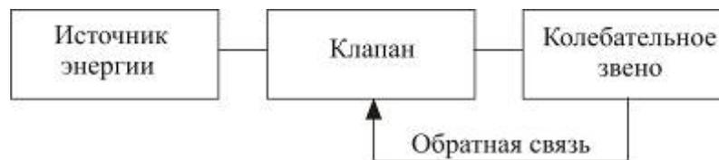
Рисунок 10 – Структурная схема типичной автоколебательной системы
