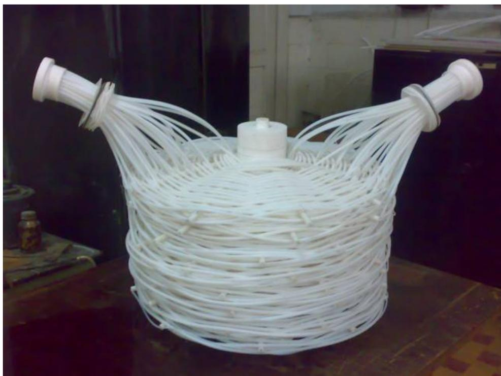
Рисунок 1 – Теплообменный аппарат объёмного переплетения из фторопласта
