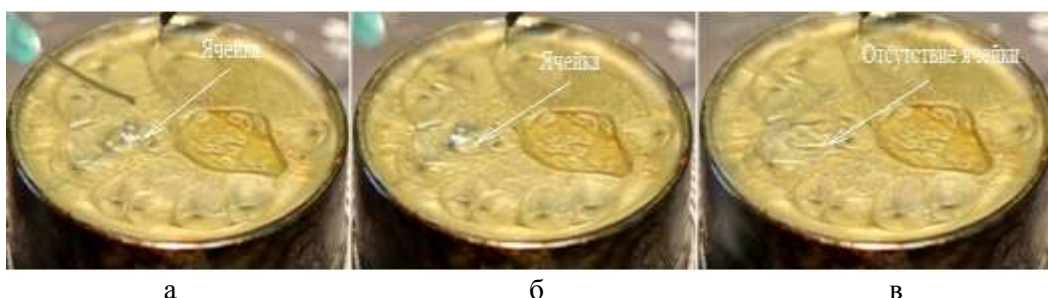
Рисунок 1 – Разрушение ячеек Бенара в вакуумном масле микрокаплей охлажденного вакуумного масла
