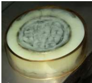
Рисунок 4 – Воздушные ячейки Бенара над ячейками Бенара из вакуумного масла
