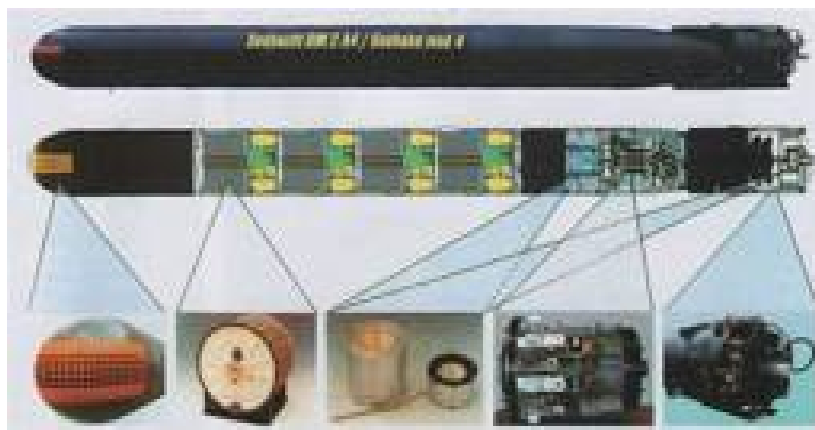
Рисунок 1 – Модульная компоновка торпеды DM2A4 «Сихейк»
