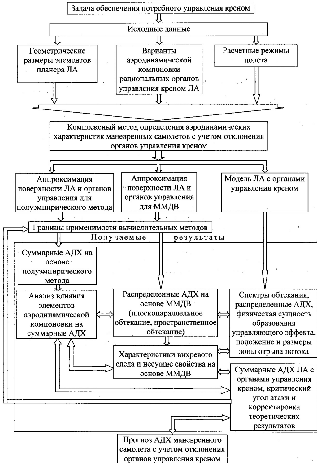
Рисунок 8 – Структурно-логическая схема комплексного метода определения аэродинамических характеристик маневренных самолетов с учетом отклонения органов управления креном
