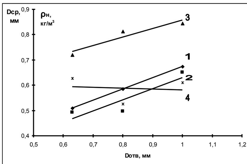
Рисунок 4 – Влияние диаметра матрицы на характеристики готовых гранул:
