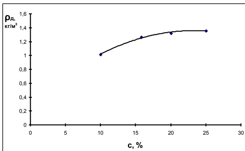
Рисунок 2 – Влияние концентрации лака на действительную плотность пороха
