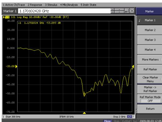
Рисунок 12 – Экспериментальная зависимость параметра  $S_{21}$  коаксиального кабеля РК-75-4-11, размещенного в высокопроводящем грунте, после воздействия МЭМИ
