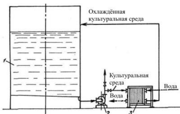
Рисунок 2 – Схема охлаждения культуральной среды с использованием выносного пластинчатого теплообменника: 1 – дрожжерастильный аппарат; 2 – насос; 3 – пластинчатый теплообменник
