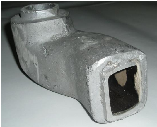
Рисунок 3 – Отливка алюминия, образовавшая головку канала цилиндров двигателя СМД 60, с внутренним теплоизолирующим покрытием
