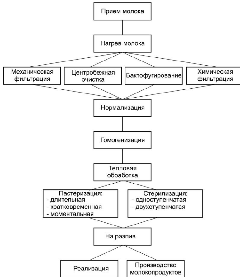
Рисунок 2 – Функциональная схема производства молока
