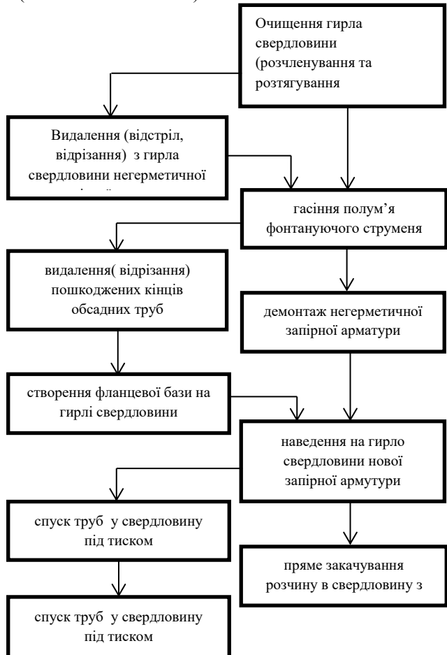
Рис. 5. Порядок проведення операцій при ліквідації відкритих фонтанів шляхом герметизації гирла свердловини з подальшим глушінням рідиною.
