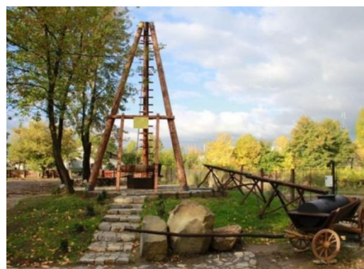
Рисунок 3 – Тринога та інше обладнання, яке у 1860-х роках використовувалась для ударного буріння нафтових свердловин у Прикарпатті
