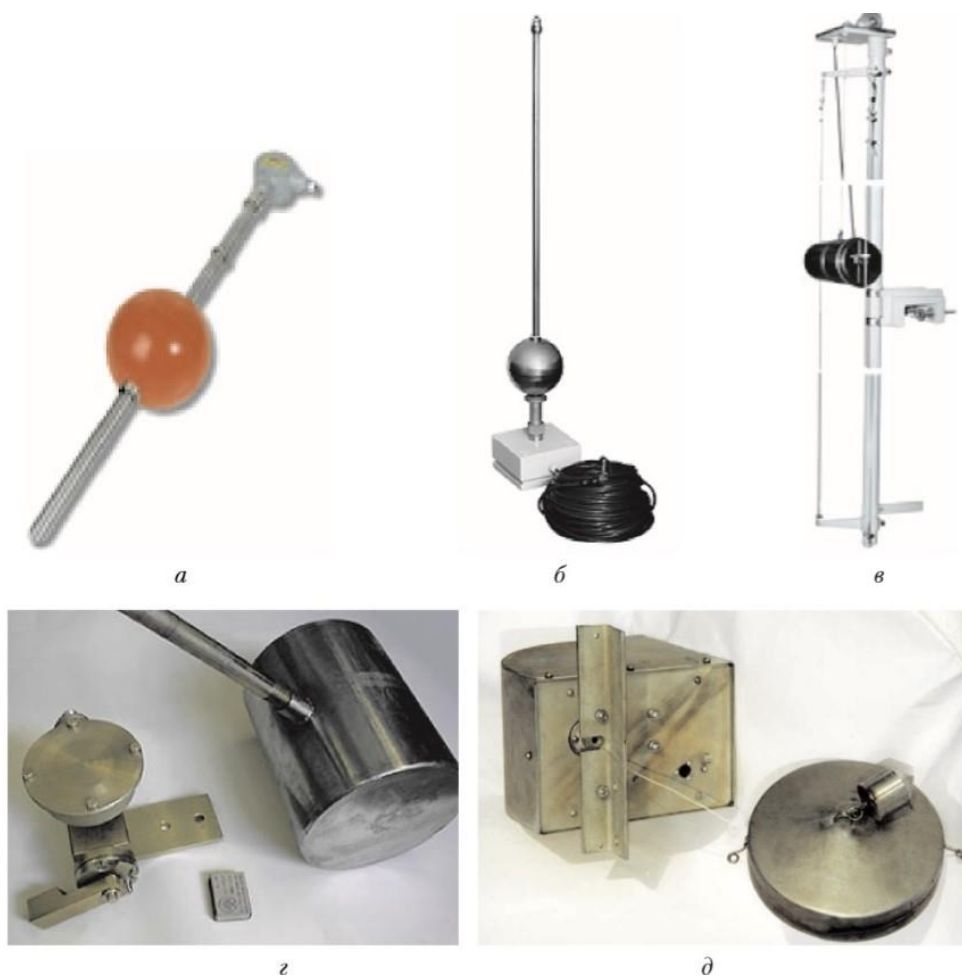
Рисунок 1 – Датчики рівня поплавкові: а – герконовий: PitLevelSensor (PLS) (Weatherford); б – магнітострикційний: Дубров (СКБ «Ореол»); в – потенціометричний ДУП-1 (ЗАТ АМТ); г – штанговий: ДУ-Ш (ВАТ НПФ «Геофізика»); д – безштанговий: УПБ-М (ТПГ)
