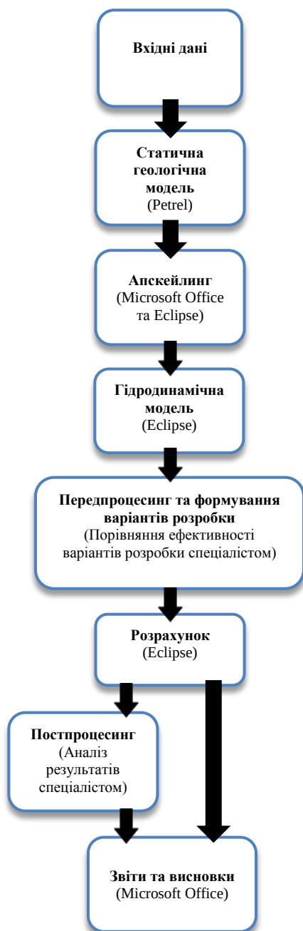
Рисунок 1 - Схема процесу геологічного моделювання
