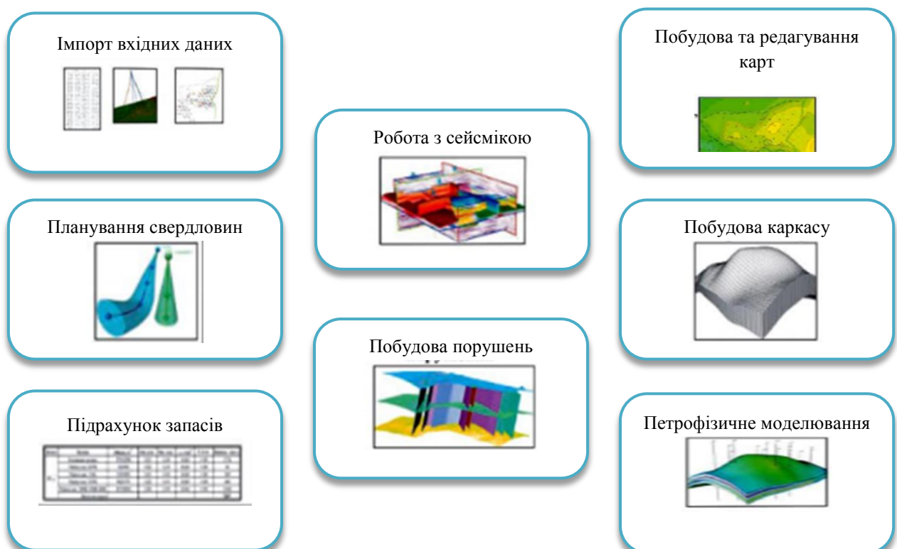
Рисунок 3 - Типовий склад пакета програмного забезпечення при геологічному моделюванні
