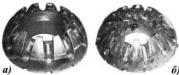
Рисунок 5. Зовнішній вигляд нового (а) і відпрацьованого (б) ущільнювача превентора фірми Shaffer
