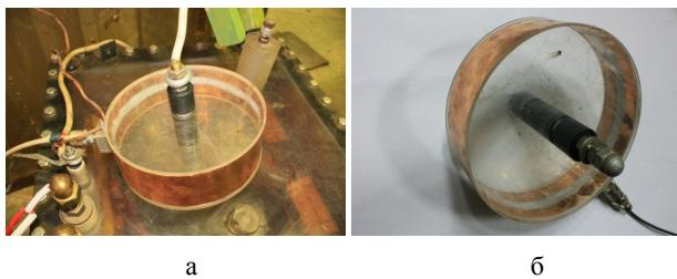
Рис. 7. Фото компактного ёмкостного делителя напряжения на 70 кВ с экранированным промежуточным электродом: а – делитель на изоляционной крышки высоковольтного импульсного трансформатора, б – делитель в сборе
