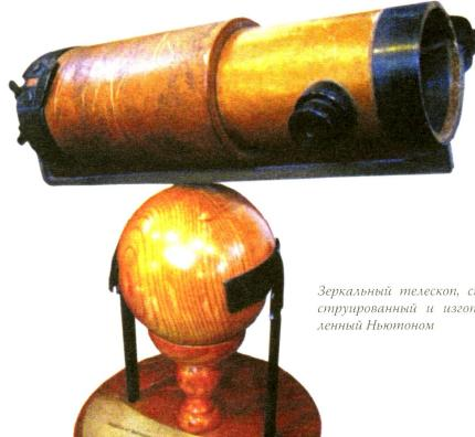
Зеркальный телескоп, сконструированный и изголовленный Ньютоном
