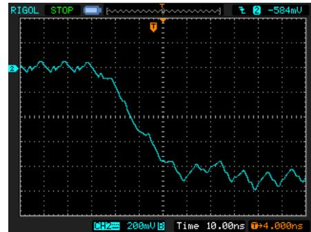
Рис. 8. Осциллограммы напряжения на резистивной нагрузке по схеме на рис. 5, измеренного при помощи созданного компактного ёмкостного делителя напряжения
