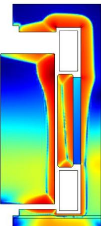
Рис. 8. Распределение модуля индукции в магнитопроводе
