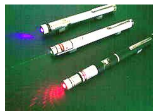
Рис. 15. Миниатюрные лазерные указки с различными цветами испускаемого светового луча (сверху вниз – указки соответственно синего, зеленого и красного цветов) [5]
