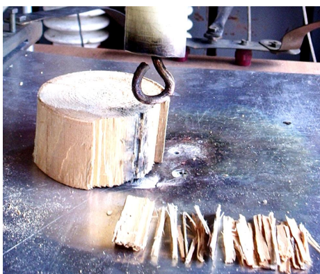
Рис. 4. Внешний вид разрушения (раскалывания) в области периферии опытного образца "мертвой" древесины сосны с помощью канала искрового разряда в цепи генератора тока искусственной молнии при U_{3A}=-7 кВ и I_{mA}=-41,4 кА [1]
