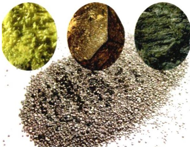
Рис. 2. Внешний вид основных компонентов дымного пороха (вверху слева-направо серы, калиевой селитры и древесного угля), применяемых при его (внизу) изготовлении [8]
