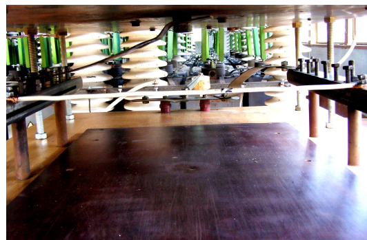
Рис. 20. Внешний вид рабочего стола ГТМ и испытываемого образца провода БПВЛ с медной жилой сечением 12 \text{ мм}^2 до совместного воздействия на него импульсной A -компоненты тока молнии амплитудой I_{mA} = -205 \text{ кА} и длительной C -компоненты тока молнии с амплитудой I_{mC} = -0,880 \text{ кА}
