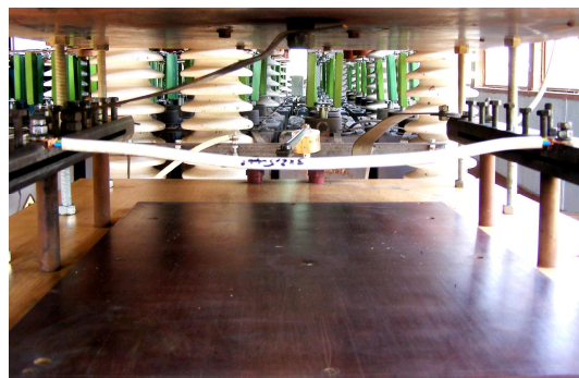
Рис. 24. Внешний вид рабочего стола ГТМ и испытываемого образца кабеля ПВС 3x2,5 с тремя медными жилами общим сечением 7,5 мм 2 до воздействия на него импульсной A - компоненты тока молнии амплитудой I_{mA} = -200 кА
