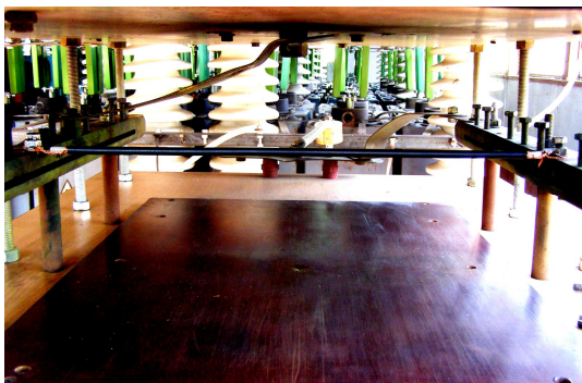
Рис. 15. Внешний вид рабочего стола ГТМ и испытываемого образца кабеля РК 75-4-11 с медной жилой сечением 0,407 \text{ мм}^2 до воздействия на него импульсной А- компоненты тока искусственной молнии с амплитудой I_{mA}=-205 \text{ кА}
