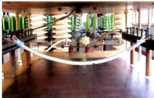
Рис. 23. Внешний вид рабочего стола ГТМ и испытываемого образца экранированного многожильного кабеля UNITRONIC LIYCY 20x0,34 Pbf с шестью его параллельно подключенными медными жилами общим сечением 2,04 мм 2 после воздействия на него длительной C - компоненты тока искусственной молнии с амплитудой I_{mC} = -0,857 кА
