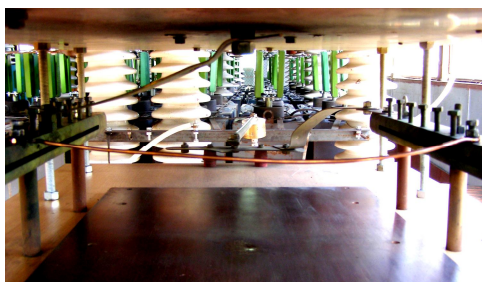
Рис. 12. Внешний вид рабочего стола ГТМ и испытываемого образца кабеля РК 75-17-31 с медной жилой сечением 10,2 \text{ мм}^2 после воздействия на него импульсной A - компоненты тока искусственной молнии амплитудой I_{mA} = -205 \text{ кА}
