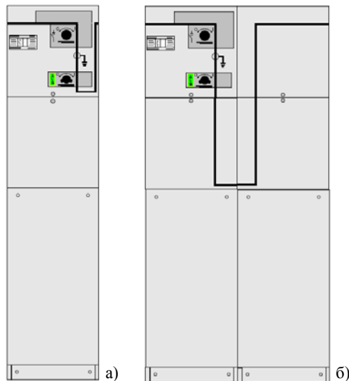
Рис. 18. Модулі для секціонування розподільних пристроїв з секційним вимикачем-роз'єднувачем
