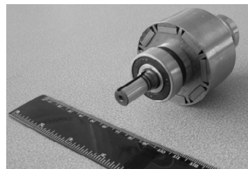
Рис. 4. Ротор макетного образца ВД с внутренними ПМ
