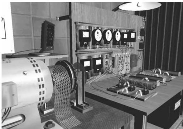
Рис. 7. Общий вид виртуального стенда с ДПТ
