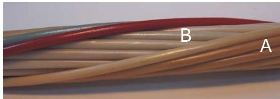
Рис. 1. Внешний вид отрезка кабеля КПВГ-27x2,5 после 20 лет эксплуатации
