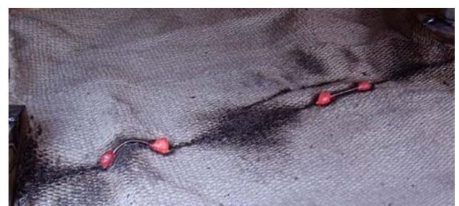
Рис. 11. Общий вид остывших макроскопических "горячих" (бывших макроскопических зон ВЭП провода) и "холодных" продольных участков провода ( $n \approx 9$ )
