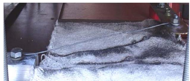
Рис. 1. Общий вид исследуемого оцинкованного стального провода до воздействия на него мощного апериодического импульса тока с амплитудой  $I_{mc}$  от генератора ГИТ-5С
