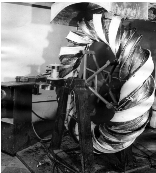
Рис. 11. Намоточный станок. Видны два винтовых полюса, для третьего подготовлен каркас
